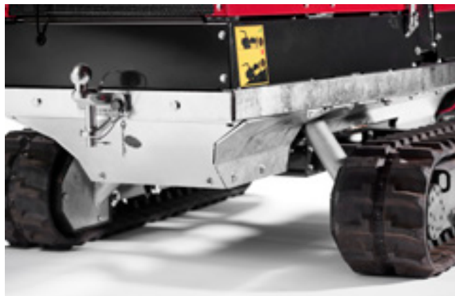
Största frihöjden på marknaden: 200 mm, enkel service och robust slangskydd
