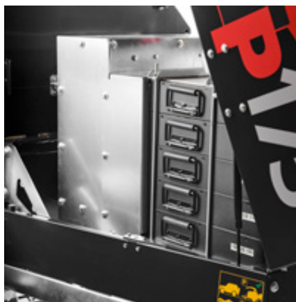
325 amp (5 timmar). Litiumbatterier (LiNiMnCoO 2 65V) ger upp till 5 timmars drift.
