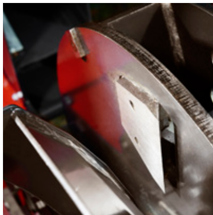
TP Opticut: Två förskjutna knivar är konstant i kontakt med materialet
