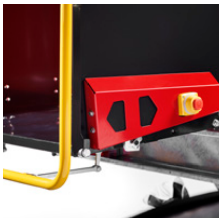
TP Easy Control. Återställning – Reversering – Inmatning. E-stopp på sidan som tillval.
