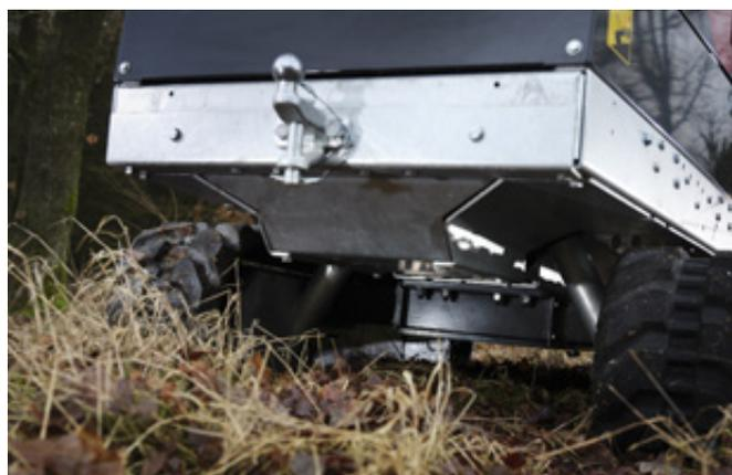
Distancia al suelo de 250 mm, fácil mantenimiento y protección de manguitos reforzada Anchura de orugas variable
