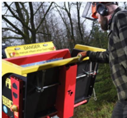
Fácil manejo del embudo reforzado y resistente gracias al resorte de gas
