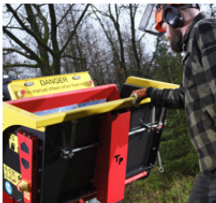
Nem håndtering af den forstærkede kraftige tragt takket være gasfjeder
