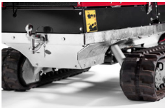
Største frihøyde på markedet: 200 mm, enkel service og robust slangebeskyttelse
